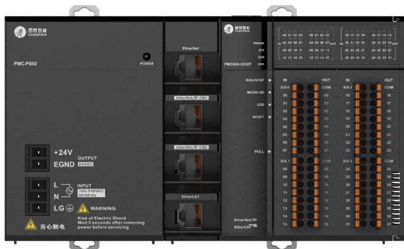
图6.4 主机与电源模块完成连接
